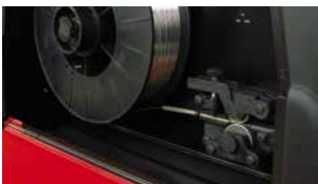
FLUX C'est comme souder une électrode sans fin.
