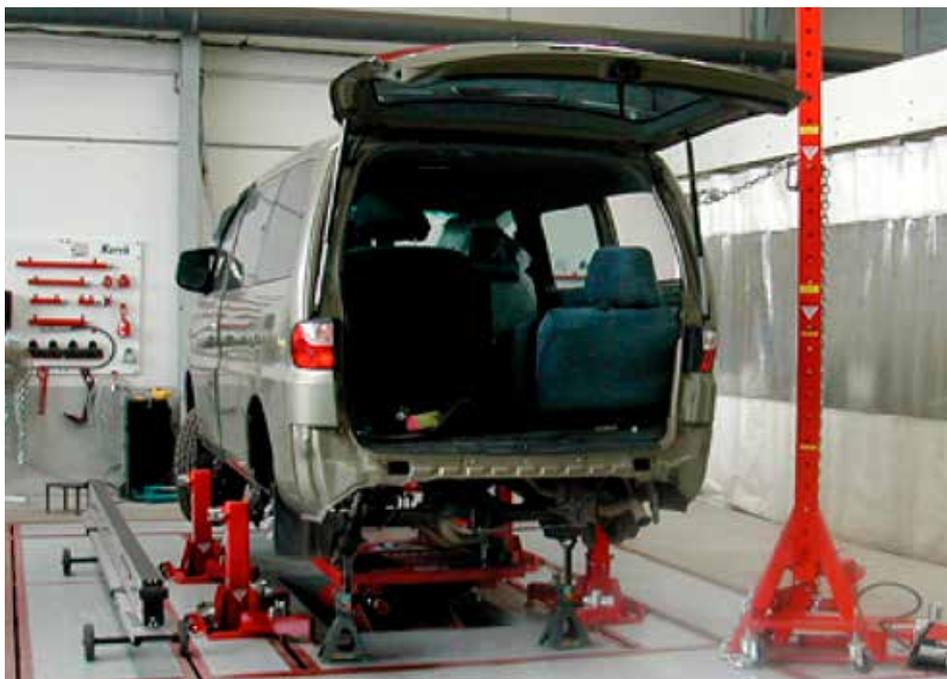
Torre di raddrizzatura 10 T particolarmente adatta per tiranti elevati
