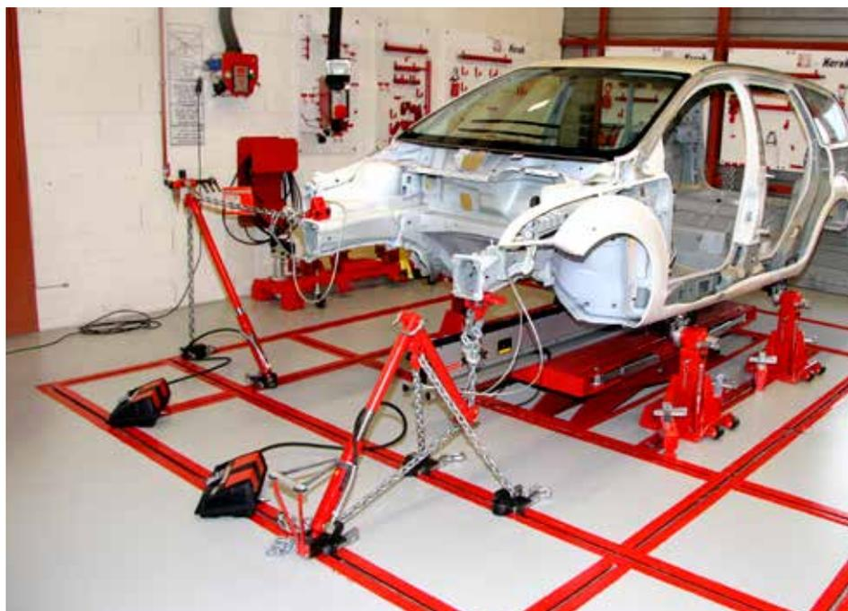
Grazie a 4 supporti sormontate da robustissime pinze, il Power Lok® mantiene il veicolo rigorosamente fissato allo telaio Korek® indeformabile. Ora accessibilissimo, il sottoscocca del veicolo mantiene la stessa posizione rigida dall'inizio fino alla fine per una riparazione efficace, veloce e precisa.
