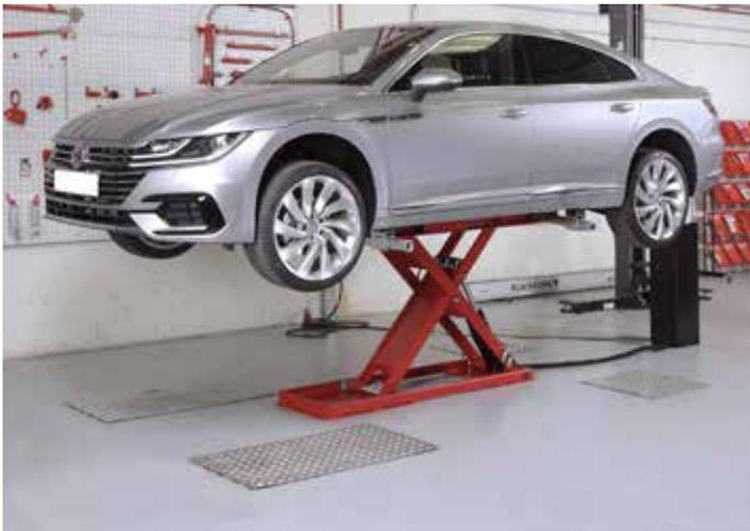
Eingebauten Hubtisch mit teleskopische Tragärme und elektrische Pumpe + Fernbedienung
