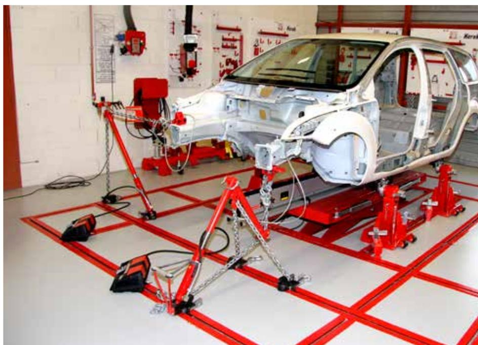
Grazie a 4 supporti sormontate da robustissime pinze, il Power Lok® mantiene il veicolo rigorosamente fissato allo telaio Korek® indeformabile. Ora accessibilissimo, il sottoscocca del veicolo mantiene la stessa posizione rigida dall'inizio fino alla fine per una riparazione efficace, veloce e precisa.
