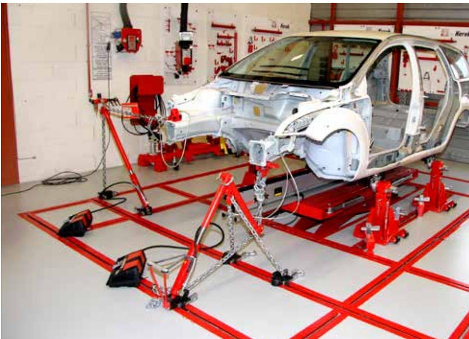
Gracias a sus 4 robustos soportes de carrocería, el power Lok® mantiene el coche a una cómoda altura de trabajo y lo mantiene sujetado firmemente en la rigidez inquebrantable del marco del Korek®. Se facilita el acceso a la parte inferior de la carrocería, manteniendo su perfecta rigidez y posición durante las reparaciones. El sistema Power Lok® asegura rapidez, eficiencia y enderezado preciso.
