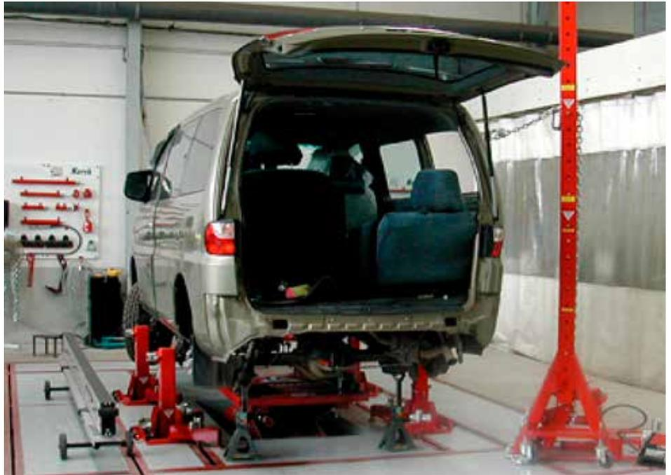
Torre de tracción 10 T especialmente adecuado para tirar en puntos altos para el sistema Korek
