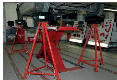
**MC PHERSON** Medición de puntos superiores
