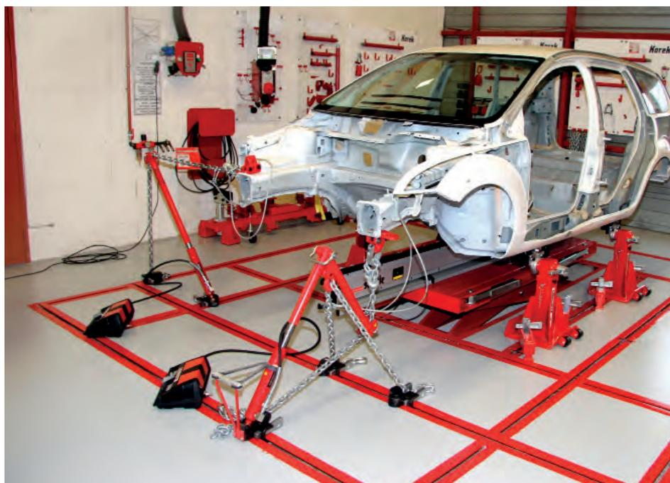
Gracias a sus 4 robustos soportes de carrocería, el power Lok® mantiene el coche a una cómoda altura de trabajo y lo mantiene sujeto firmemente en la rigidez inquebrantable del marco del Korek®. Se facilita el acceso a la parte inferior de la carrocería, manteniendo su perfecta rigidez y posición durante las reparaciones. El sistema Power Lok® asegura rapidez, eficiencia y enderezado preciso.
